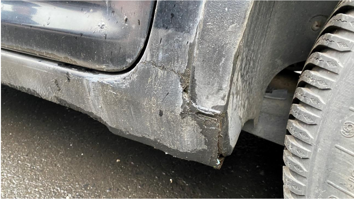
Rozsáhlá koroze prahů a blatníků
