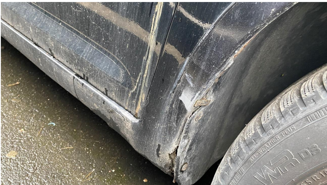
Rozsáhlá koroze prahů a blatníků
